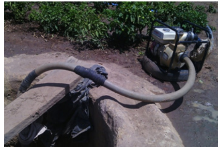
Figure 10 : Type de motopompe utilisé comme moyen d'exhaure
